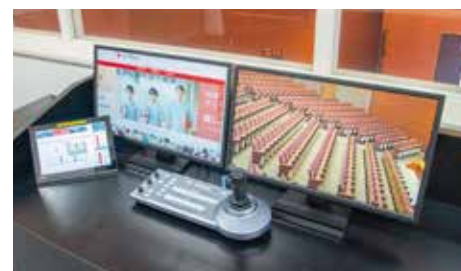
調整室には演台のシステムに加えてリモートカメラのコントローラーを配備している。
