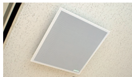
音声をマルチゾーンで収音するシーリングアレイマイク。
